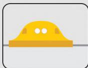
Colocar la boya apuntando los reflejantes con dirección al conductor según el sentido de la calle. / Place the round road marker exposing the "cat's eye" toward the motorist, according to the current traffic orientation.
