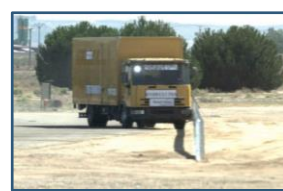
Ensayo 4-12 Camión de 8000 kg a 80 km/h y 15°
