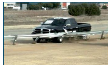
Ensayo 3-11 Camioneta de 2.270 kg a 100 km/h y 25°
