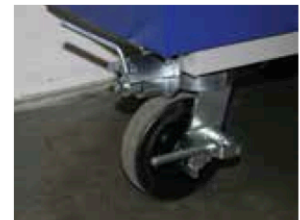
Sistema de ruedas traseras con liberación y freno.
